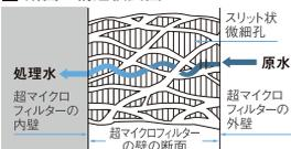
水は右から左へ、ヘチマのような構造体の隙間をくぐっていきます。この隙間を通ることができないバクテリアや微粒子は膜の中に入れません。
