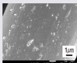
プラチナウェーブ繊維を高分解能走査型電子顕微鏡で10000倍にて撮影したところ、微細な微粒子が、繊維にバランスよく練り込まれていることが確認された。
